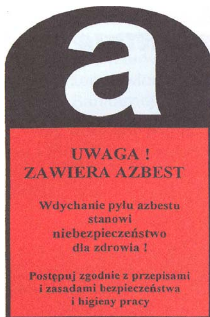
Rys. 7 Oznakowanie wyrobów i odpadów zawierających azbest, wysokość znaku powinna wynosić co najmniej 5 cm, a szerokość co najmniej 3 cm
